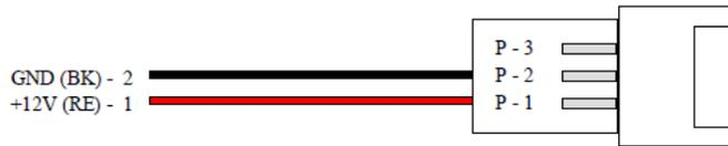
**Cable adaptador de voltaje (101)**
